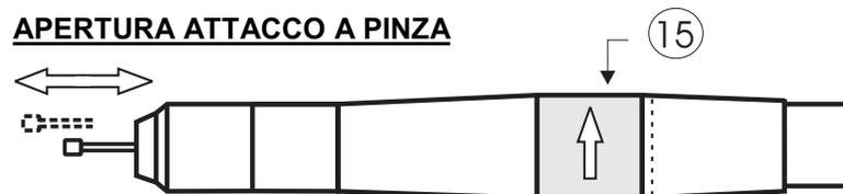
Ruotare l'anello di serraggio (15) nel senso indicato dalla freccia fin quando non si blocca.
