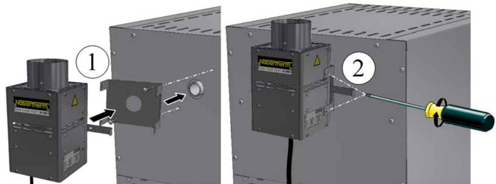
Fig. 18: Vent with fan
