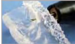
**1.** Découper la forme finale avec la fraise à spirale HSS (sans pression, > 20 000 tr/mn), laisser suffisamment de matériau (au moins 2 mm) autour des points de fixation.
