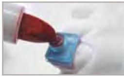
**14.** Marquer la surface extérieure des quatre espaceurs avec un stylo flipchart. Encastrer les modèles dans les granulés, maintenir au moins 6 mm au-dessous des...
