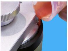
Nach dem Aushärten der drei Fixierungspunkte wird der restliche Zwischenraum des Justiersockels ausgegossen.
