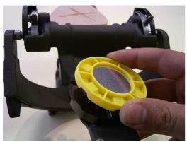
Als nächstes wird der Sekundärsockel auf den Justiersockel aufgelegt und mit einer Haftscheibe befestigt, die in die dafür vorgesehene Ausnehmung gesetzt wird. Hierbei ist darauf zu achten, dass alle Kontaktflächen frei von Schmutzpartikeln sind.
