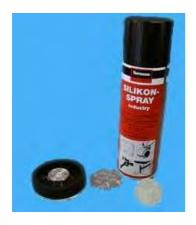
Um Anhaftungen zu vermeiden werden Gummiring und Mater mit Silikontrennmittel besprüht.
