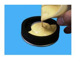
Zur besseren befestigung des Modelle sollte etwas Noppenfolie auf den noch weichen Gips gelegt und anschließent wieder entfernt werden.
