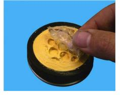
Um den ausgehärteten Gipssockel zu lösen, wird einfach Pressluft durch das Loch auf der Materrückseite geblasen.
